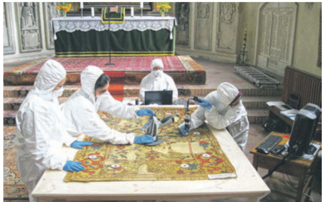
Schadstoffscreening mittels Röntgen-Fluoreszenz-Analysegerät im Sommer 2014 in der evangelischen Kirche zu Mediasch.
